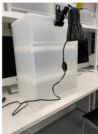
図1 引き出しを3つ縦に重ねたものにフルカラーLEDを取り付けた様子
