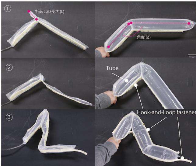
図 3 Reflatables の角度指定の方法 (1),(2) 折返しの長さを変えることで角度変更が可能. (3) 両面に面ファスナを張り合わせることで異なる方向に屈曲が可能.
