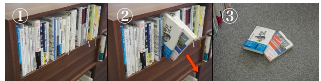
図3 本棚に入れた本がデバイスの作動により床に落ちる流れ
