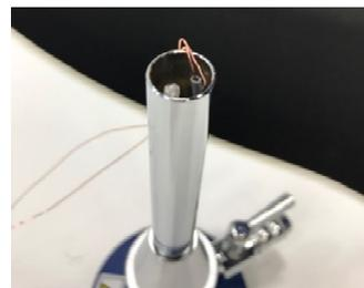
図4 ガスバーナーの筒内部のフォトトランジスタ
