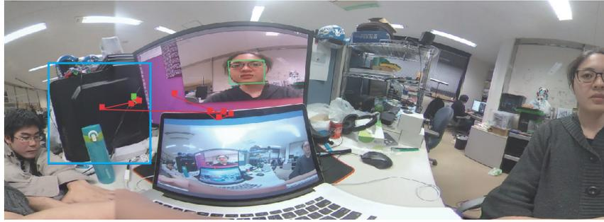
図 1 全天球カメラを用いた視線検出システム想定．赤点が過去の視線位置，緑点が現在視線位置，青枠が対象物を表す．
