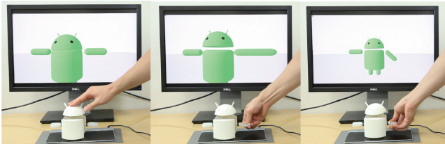
図 8 パーチャルキャラクターのための物理コントローラ。頭を押すと首が縮む (左), 腕をつまむと伸びる (中央), 腕のパーツを曲げ入力に替えると腕が曲がる (右)。
