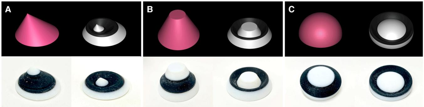
図 5 インタフェース上での表示と実際に印刷した物体の比較. A: 斜円錐. B: 円錐台. C: 半球. 全て先細り形状であり, 本提案によって高さ方向に折りたたみ 3D プリントを実現した.
