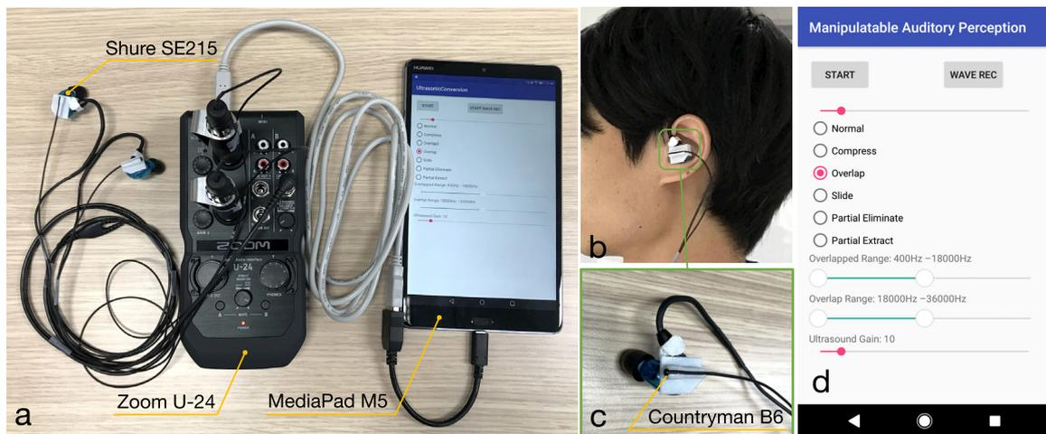
図3 (a) 実装したプロトタイプデバイス (b) デバイス装着時 (c) イヤホンとマイクの詳細な外観 (d) 実装した Android アプリケーション
