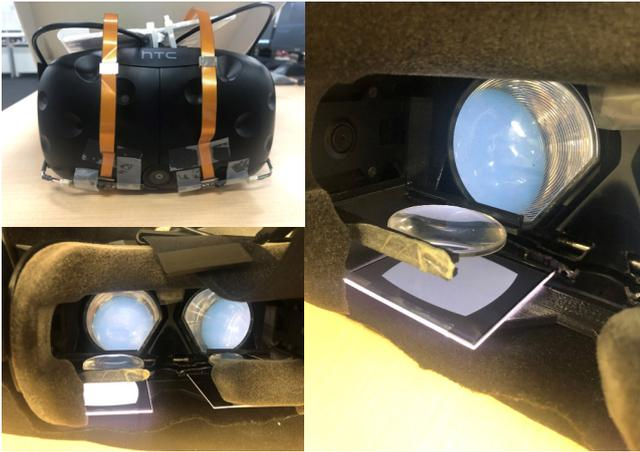
図 2 作成したデバイス。構造を見えやすくするために一部スポンジを取り外している (左上：正面図，左下：背面図，右：レンズと LCD 部分の拡大図)
