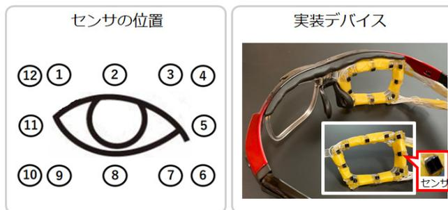
図 2 プロトタイプシステムのセンサ位置とセンサデバイス
