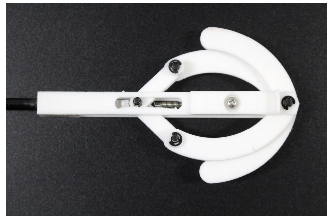
図 3 鼓動を再現する機構
