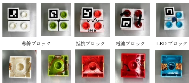
図 8 電子ブロックの内部構造の例
