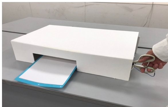
図8 ハサミでカッティングマシンを動かすシステムを使用する様子
