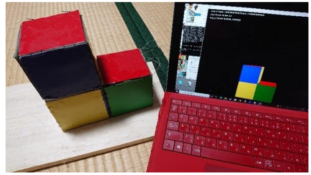
図 8. 8 章のコマンド列が生成されたときの Real な「物」と Virtual 空間で再生された「物」
