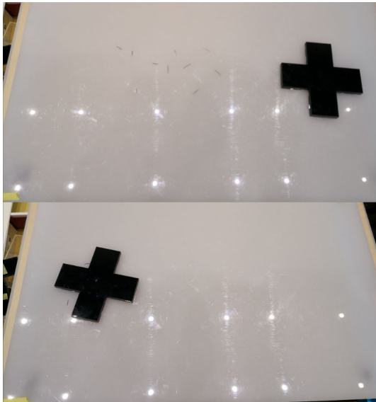
図 7 X 字型除去バーの開始位置（上）と終了位置（下）
