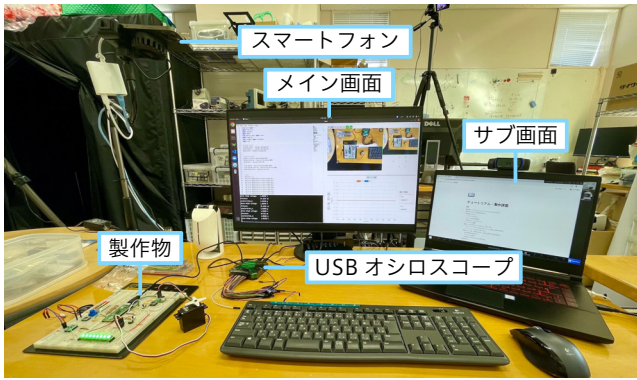
図 2 ハードウェアツールの構成と机上での配置
