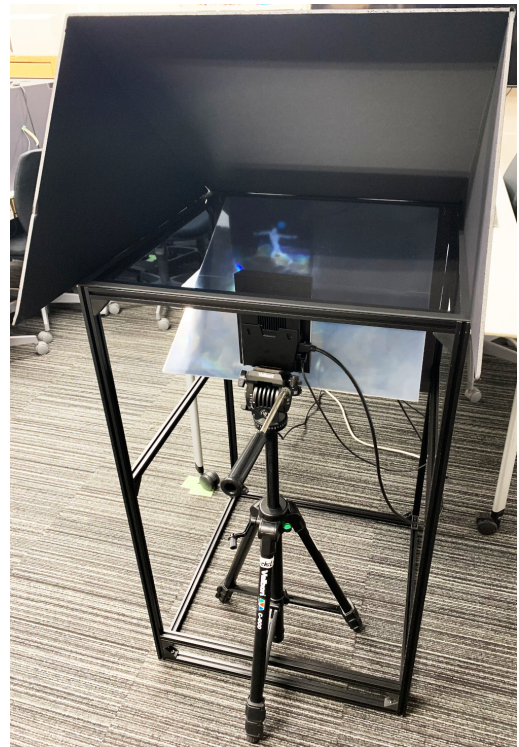
図 1 試作したテーブル型の空中立体映像投影装置
