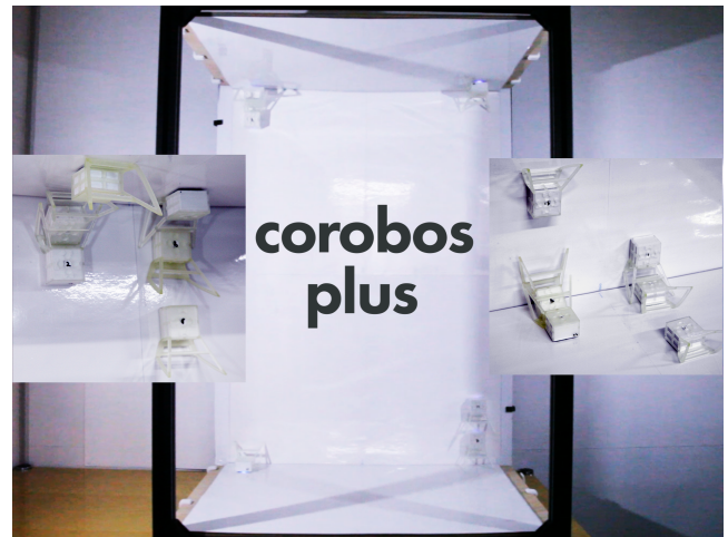
図 1: 卓上・壁面・天井の間を移行する群ロボット: corobos plus
