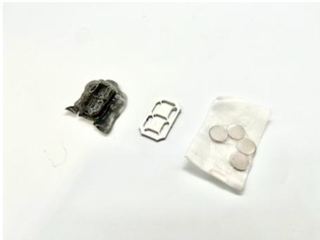
図2 磁性熱可塑性樹脂、型、磁石
