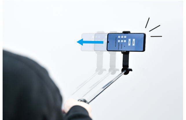
図 1 自撮り棒を動かすことによるジェスチャ入力インタフェース
