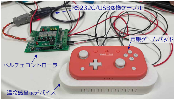
図 1 温冷感呈示機能を有するゲームコントローラシステム。
