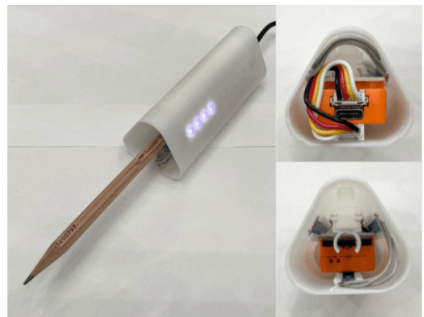
図 2 デバイスの全体像 (左)、ペンの頭部方向から見たデバイス (右上)、ペン先方向から見たデバイス (右下)
