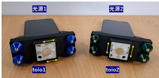
図 6 光源 1 および光源 2 を運ぶ台の形状
