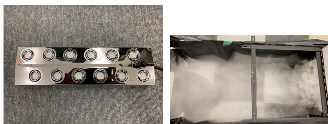
(a) ミスト生成器 (b) ボックス内のミストの様子
