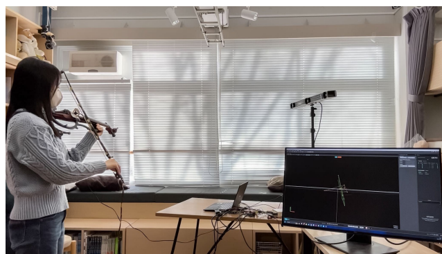
図1 モーションキャプチャと力覚センサによるバイオリンの演奏動作計測
