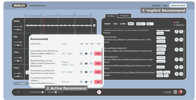
図 1: 開発した MARLEY のインターフェース. (1) 4x4 のグリッドに自由に音源素材を配置する. グリッド内の音源は左から右に再生され全 8 ページを利用でき, 既に挿入したループを次ページへとコピーする機能を持つ. (2) ループ音源素材のライブラリビューアでは, 音源の試聴とファイルのメタデータの確認が可能. 2 種類の推薦モードがあり, 各マスに対してループ音源リストがポップアップする (3) Active Recommend 機能と, 合いそうな音源を自動的にライブラリビューア上位に表示する (4) Implicit Recommend 機能が利用できる.
