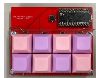
図 1 自作キーボードの例
