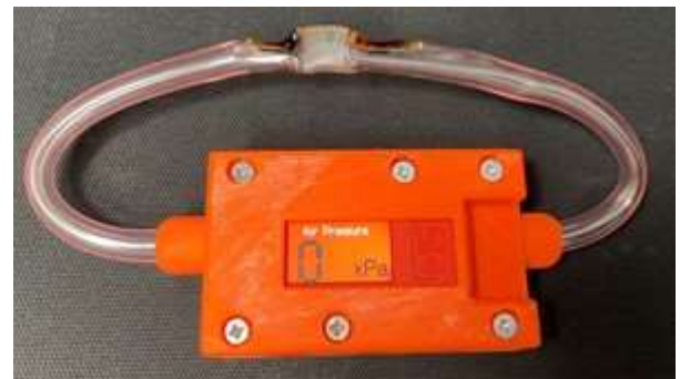
図 2 片噛み検出可能な提案装置(TBMS-D)概要
