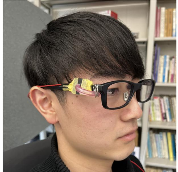
図 2 眼鏡型反射性瞬目誘発デバイスを装着した様子
