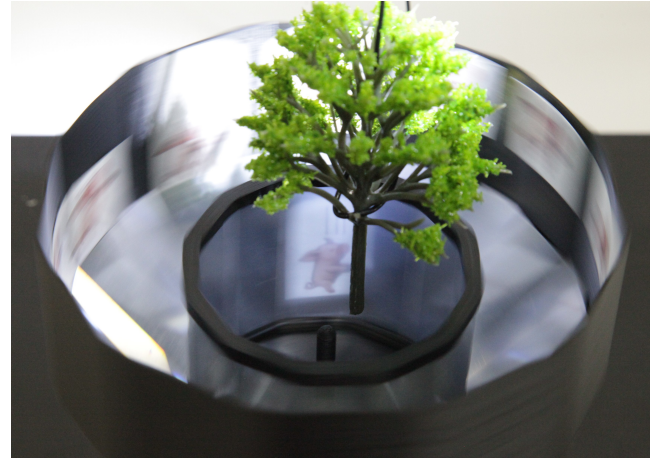
図 5: 回転させた様子。周囲のイラストは高速に動くが、空中像の位置は回転軸上から動かないため見ることができる
