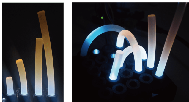
図 9 スティックの長さによる発色の差 (左), 底面から LED で照らしたものを真横から見た図 (左から 1/3 、 1/2 、 2/3 、 1 ). 立体的な配置の作例 (右).
