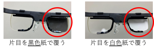
図 2 実験において瞳孔径を制御する手法
