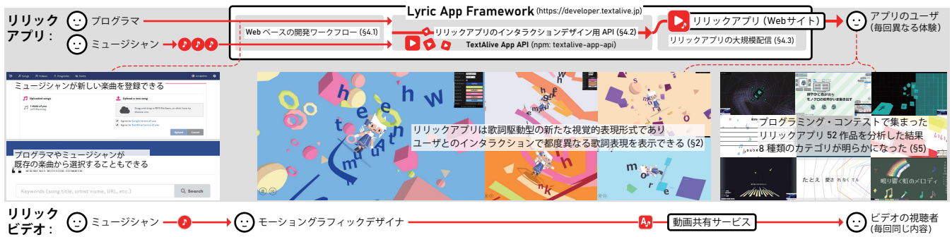
図 1: 「リリックアプリ」は、ユーザーが歌詞駆動の視覚表現とインタラクションできるようにすることで、リリックビデオの限界を突破する新たな表現形式である。本稿で提案する「Lyric App Framework」はプログラマとミュージシャンによるリリックアプリ開発を支援する。
