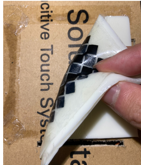
図 2 3mm の表面素材を取り付けた触覚センサの柔軟性
