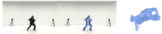
図6 BEV [35]を用いて、単一のRGB画像から3D人型モデルを作成する方法。入力画像(左)、入力画像上に重ねられた3D人型モデル(中央)、上から見た3D人型モデル(右)。
