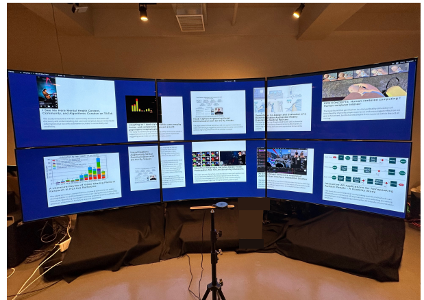
図 2 Serendipity Wall は6台の曲面 4K ディスプレイとマイクから構成され、議論の内容に応じた関連情報を提示する。
