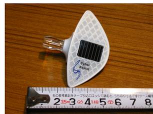
図 14 セラミックイヤホンタイプの CoBIT
