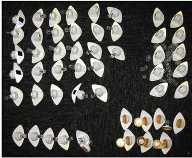
図 17 セラミックホンタイプの CoBIT の破損状況
