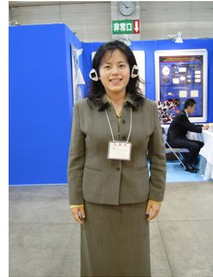
図 19 耳掛けヘッドホンタイプの CoBIT の装着例
