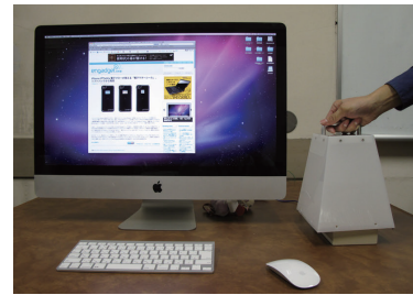
図 2 InfoLantern を PC のそばに置くことによる情報の詳細表示 Fig.2 Detailed information is displayed when InfoLantern is placed beside a PC.
