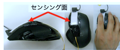
図 7 プロトタイプ (マウス実装型). Fig. 7 The prototype implemented in the mouse.
