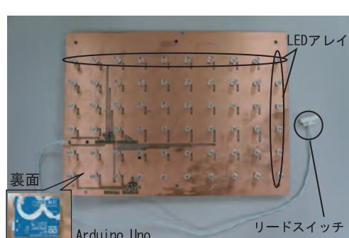
図 4 RefrigeMeter のデバイス構成 (左: プロトタイプ 1, 右: プロトタイプ 2)
