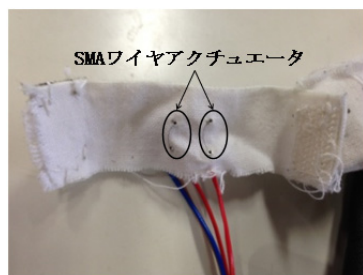
図 5 SMA ワイヤアクチュエータ部 Figure 5 Two SMA actuators fixed on finger tip
