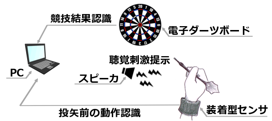
図 2 ダーツゲームを競技としたシステム構成
