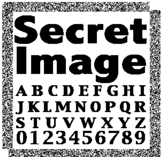
図 5 復号結果 (排他的論理和) Fig. 5 Decrypted result with XOR operation.
