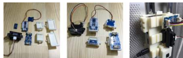
図 5 センサとその固定具の一例。
