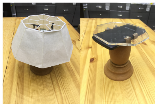
図 7 ベースステーションで待機状態のランプシェードローン (左) とベースステーションの構成 (右)
