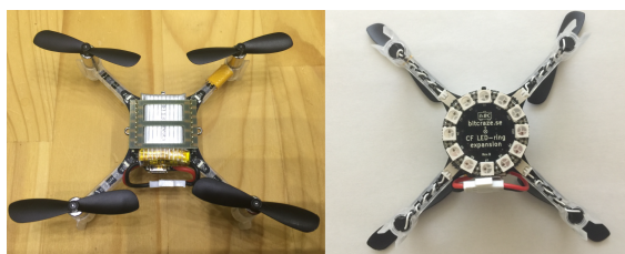
図 5 左: Crazyflie2.0 右: LED リングを装着した下面
