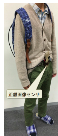
図 4 センサの取り付け状態 Fig. 4 Mounting state of the sensor
