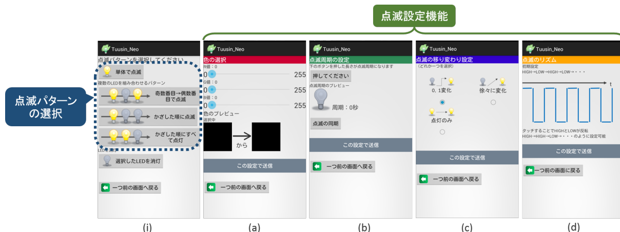
図3 イルミネーション設定用アプリケーションのスクリーンショット ((i) 点滅パターン, (a) 点滅色, (b) 点滅周期, (c) 点滅遷移, (d) 点滅リズム)
