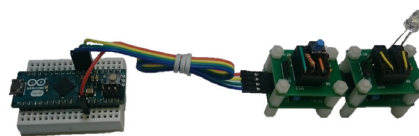
図3 「Broccoli」によるLED点滅回路
