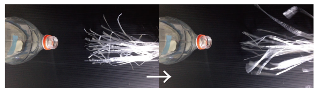
逆ノコギリ波空気砲 (3回繰り返し) を発射した様子
