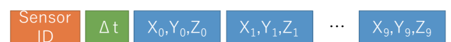
図 3 packet 構造: \Delta t はシステム起動からの経過時間、 x_i, y_i, z_i は 10 個の連続した測定値をあらわす。
